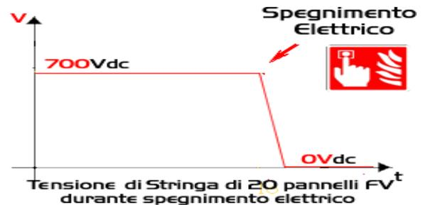
Terminée la nécessité de messe en sûreté, il sera possible de recommencer la production d'énergie, en interagissant simplement avec le Master électronique "ES" ( unité de contrôle) du système SCS.
